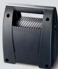
Akku-Pack Nennspannung 12 V DC, Nennkapazität 15 Ah, Nutzungsdauer 40 Tage bei max. 4 Öffnungen pro Tag und bei einer Temperatur von 20 °C, Temperaturbereich - 15 ° bis + 45 °C, integrierter Laderegler für Steckernetzteil • Geeignet für: Novomatic 423 Accu
