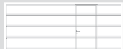
Asymmetrische Anordnung bei Torbreite BRB 4251 - 5000 mm – aus der Mitte links oder rechts
