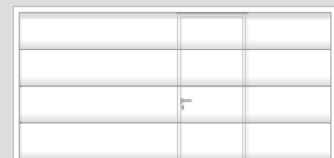
Asymmetrische Anordnung bei Torbreite BRB 3501 - 4250 mm – aus der Mitte links oder rechts
