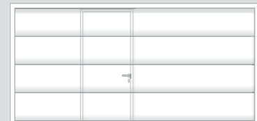
Symmetrische Anordnung bei BRB 2000 - 3500 mm nur mittig.
